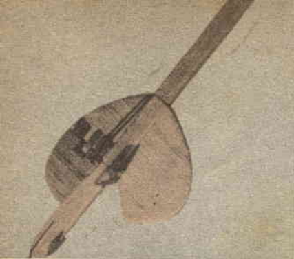
Particolare del direzionale mobile e dell'attacco del piano di coda
