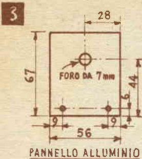
Schizzo di come deve essere preparato il pannellino frontale dell'apparecchio, in alluminio
