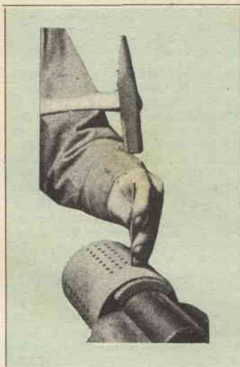
Sistema per praticare ben netti i fori nel barattolo: poggiare questo sulla incudine, su di un blocchetto di piombo curvo, usando un punzone od una fustella
