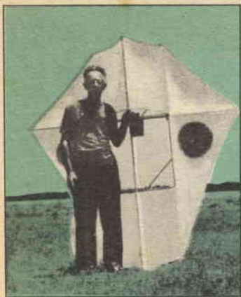
La macchina già fissata sull'apposita tavoletta, leggermente spostata rispetto alla linea centrale del cervo volante, in modo che il suo obiettivo non sia ostruito dal filo di traino del cervo stesso
